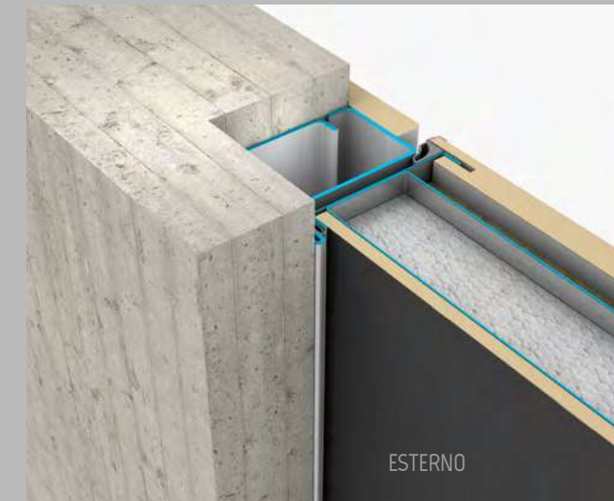
A Soluzione telaio filo muro interno ed esterno. Anta FM complanare con cornice di rifinitura sp=14mm disponibile nella stessa finitura del rivestimento
